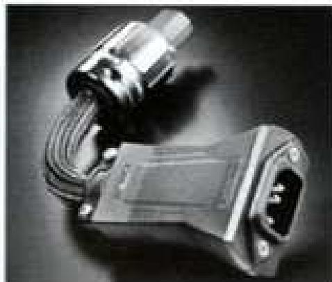
パソコンなどのデジタル家電機器から発せられる高周波ノイズを除去する、アダプタータイプのフィルター内蔵型給電ユニット。先行して発売された上位機 Flux-50 フィルターから、よりリーズナブルなモデルとして開発された。ボディは制振性のある特殊樹脂を採用。インレットコネクターは直列コイルとコンデンサーによるフィルターとを一体化した構造で、内部にはエポキシ材を充填したカスタム品を用いており、100kHzで約8dB、500kHzで約14dBのノイズ減衰効果を持たせている。また、電磁波吸収材GC-303も投入され、インレットプラグはFI-28 (R) を採用。ケーブルはOCC素材による $\alpha$ -導体や2重シース、ナイロン編組外装を採用する。
